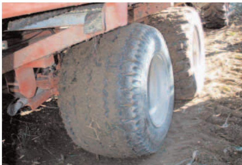
Tandemachse und Breitreifen auf dem Anhänger tragen erheblich zur Bodenschonung bei.
